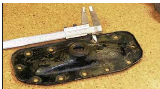
⑥ Posuvným meradlom odmeráme priemer dier vo veku.
