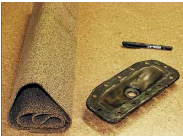
③ Pripravíme si materiál – korkovú gumu o hrúbke 2,5 mm, ale môže byť aj inej podobnej hrúbky.
