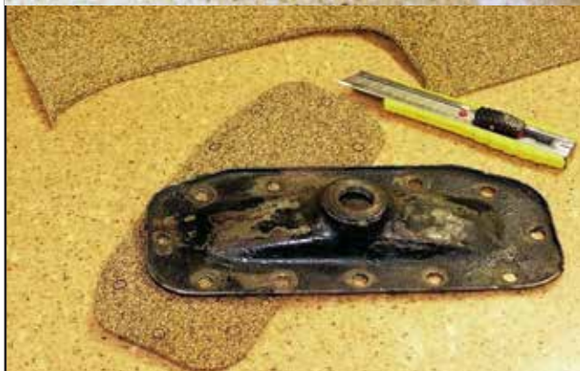
⑤ Ostrým nožom vyrežeme vonkajší tvar tesnenia, pričom veko slúži ako šablóna.
