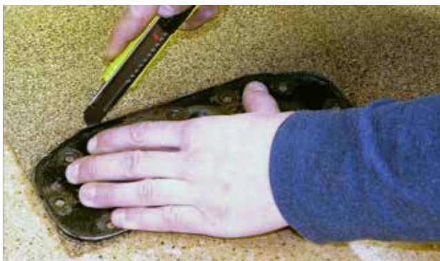
③ Pripravíme si materiál – korkovú gumu o hrúbke 2,5 mm, ale môže byť aj inej podobnej hrúbky.
