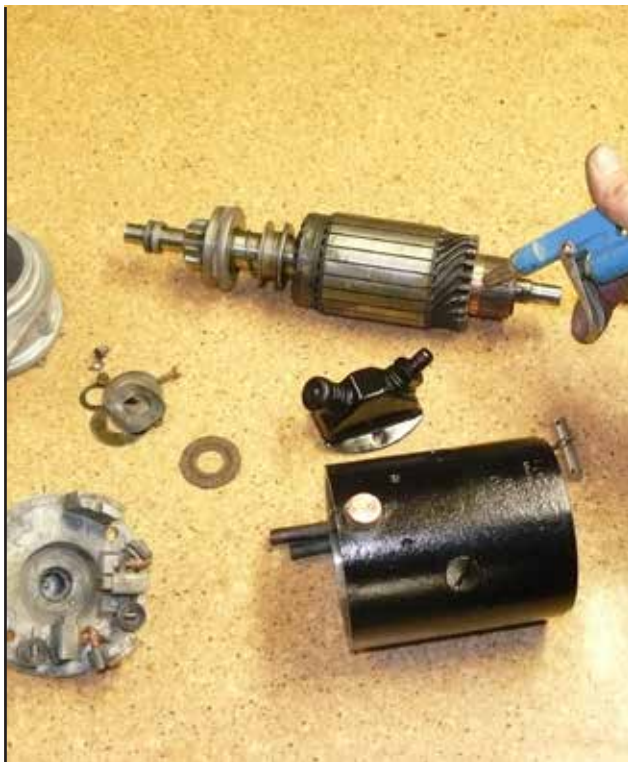
⑬ Pred samotným zložením ešte všetky časti očistíme a osušíme stlačeným vzduchom.
