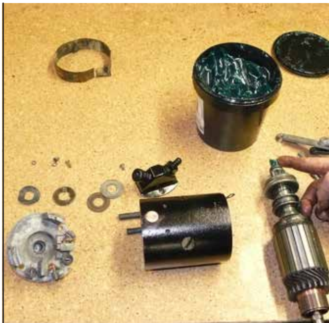
⑭ Spúšťač skladáme v opačnom poradí ako sme postupovali pri jeho rozoberaní. Nesmieme zabudnúť na premazanie všetkých častí, u ktorých dochádza ku treniu – teda pastorka a jeho voľnobežky a hlavne kĺzných ložísk nazývaných tiež púzdra. Na mazanie použijeme plastické mazivo vhodné pre kĺzne uloženia.
