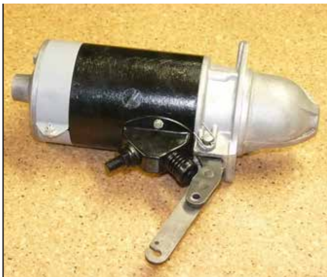
⑯ Zmontovaný štartér vždy pred namontovaním odsúkšame. Vykonáme tak pripojením ku akumulátoru – nie ku bežnej nabíjačke, keďže tá nedisponuje dostatočným elektrickým prúdom pre správnu funkciu spúšťača.
