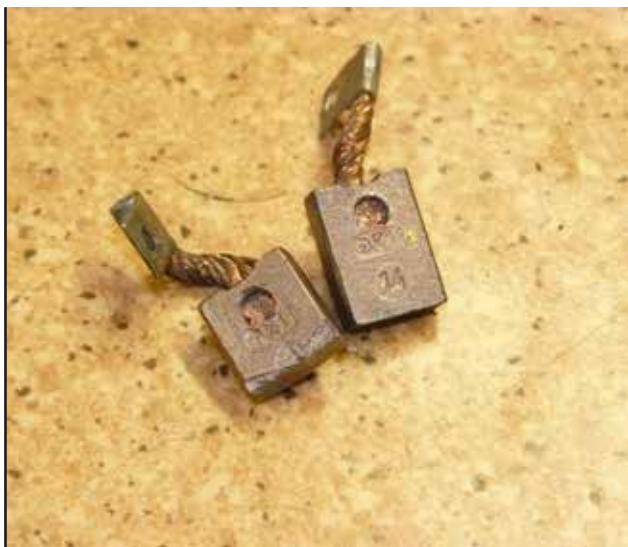
⑮ Na záver vložíme do držiakov v zadnom veku štartéra uhlíky. Tie by mali byť kompaktné a bez trhlín. V prípade podozrenia na priveľké opotrebenie uhlíkov je lepšie hneď zamontovať uhlíky nové.
